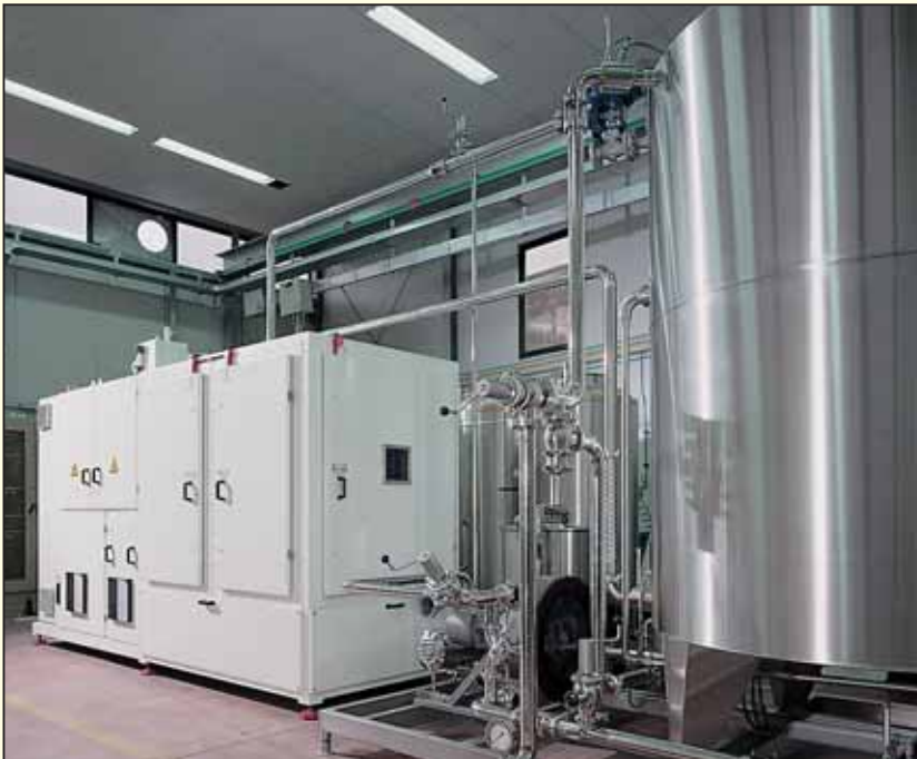
Equipement "RF/L 70 kW" pour la stérilisation en continu de préparations de fruits. Anlage "RF/L 70 kW" zur Sterilisierung von Fruchtfleisch im kontinuierlichen Verfahren.
