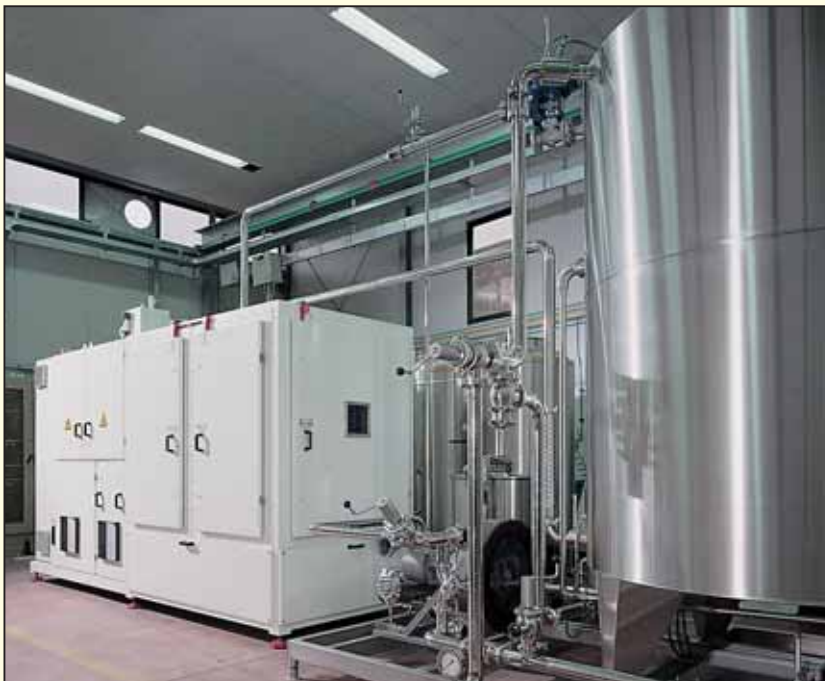
Impianto "RF/L 70 kW" per la sterilizzazione in continuo di polpa di frutta. "RF/L 70 kW" equipment for the sterilisation of fruit pulp.
