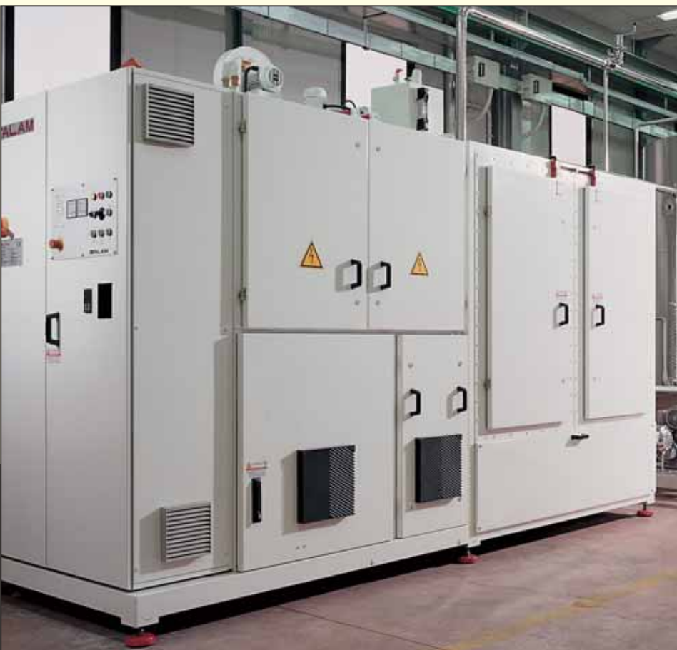
Impianto "RF/L 70 kW" per la pastorizzazione o sterilizzazione in continuo (in tubo) di prodotti liquidi. "RF/L 70 kW" equipment for the pasteurisation or sterilisation of fluidised products in the tube.
